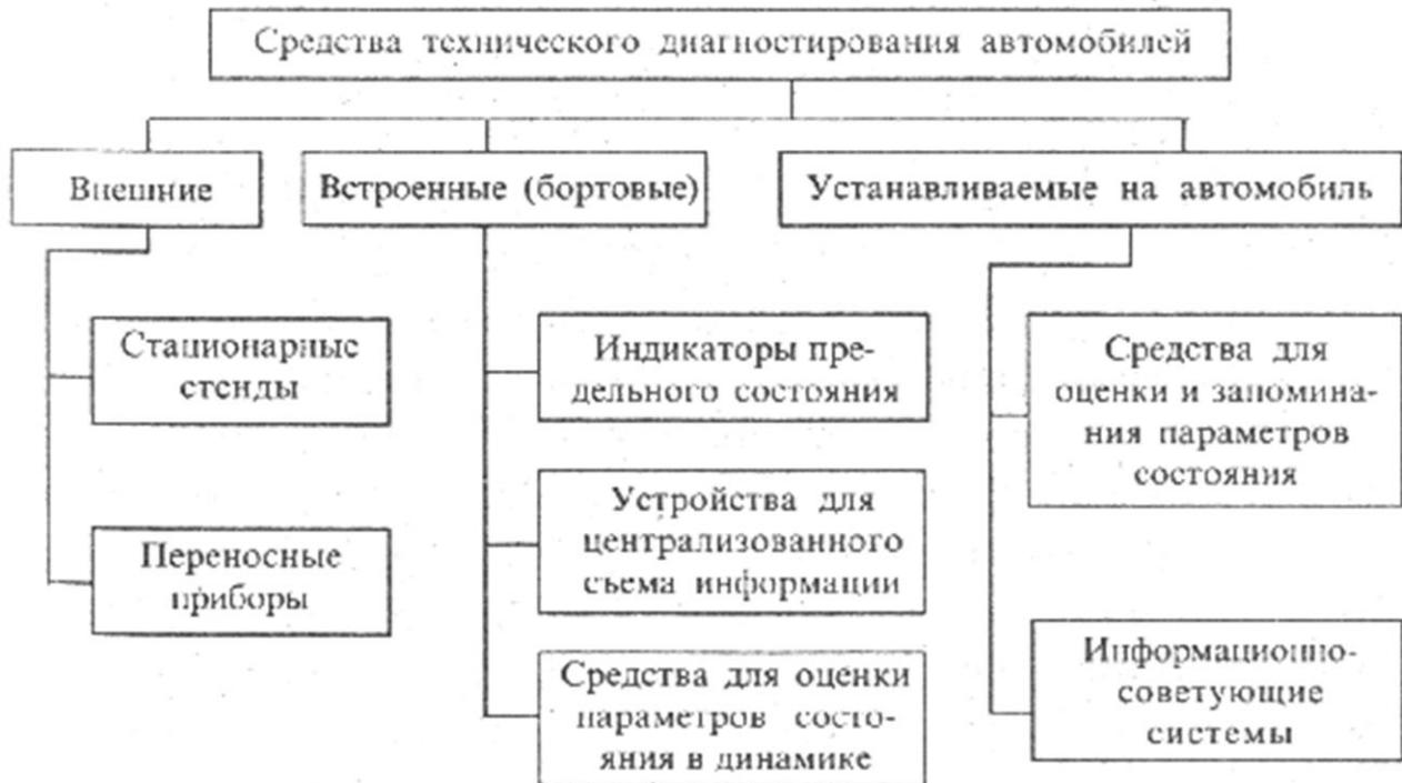
Рис. 1. Классификация средств технического диагностирования автомобилей
