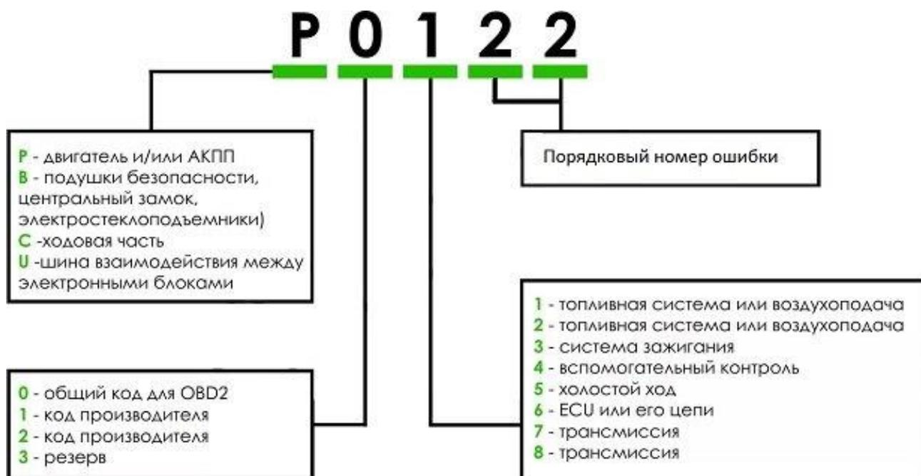
Рис. 2. Расшифровка кодов неисправностей OBD-II
