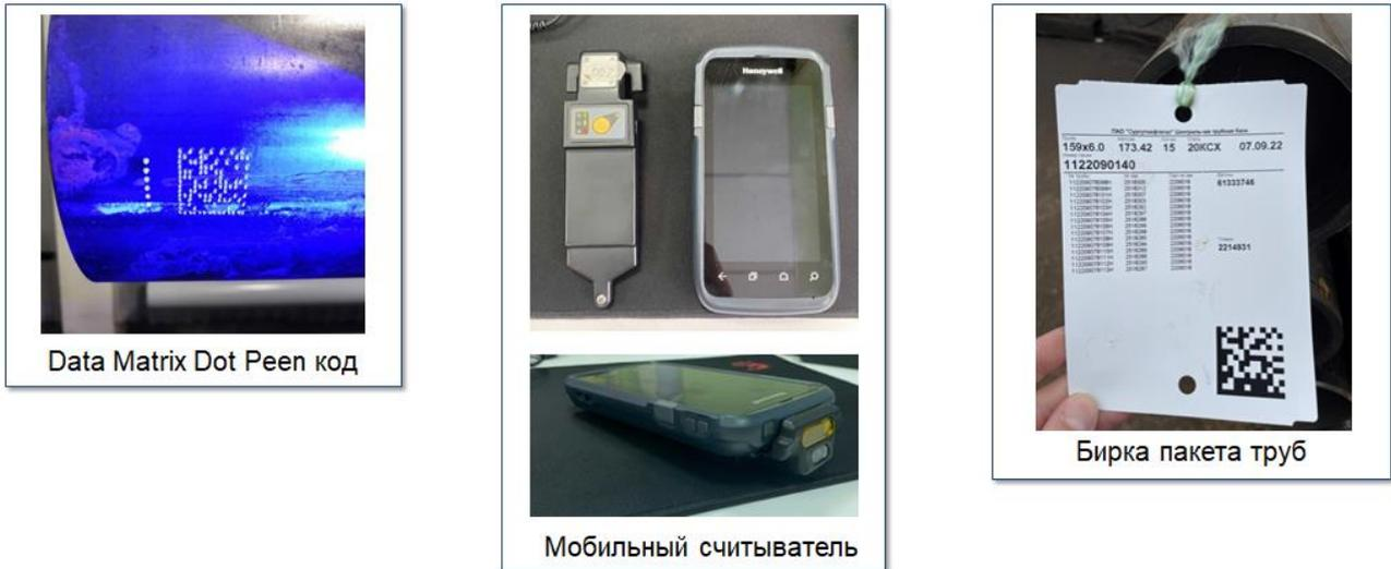
Рис. 2. Маркировка труб
