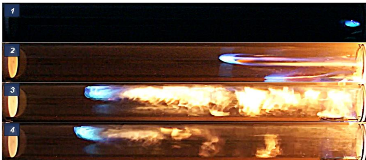
Рис. 4. Распространение фронта пламени по всей длине трубы
