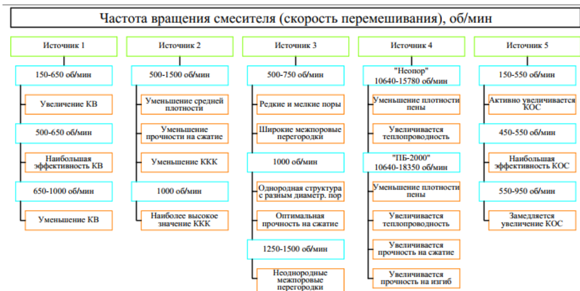
Рис. 1. Влияние скорости перемешивания смесителя на свойства пенобетона
