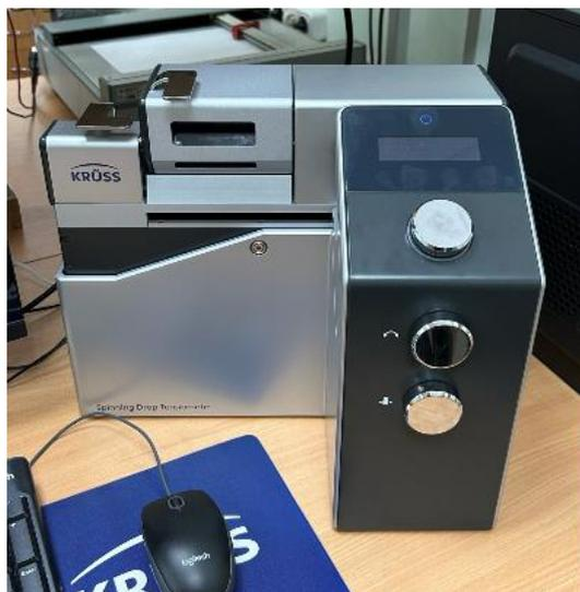
Рис. 2. Прибор для определения коэффициента поверхностного натяжения
