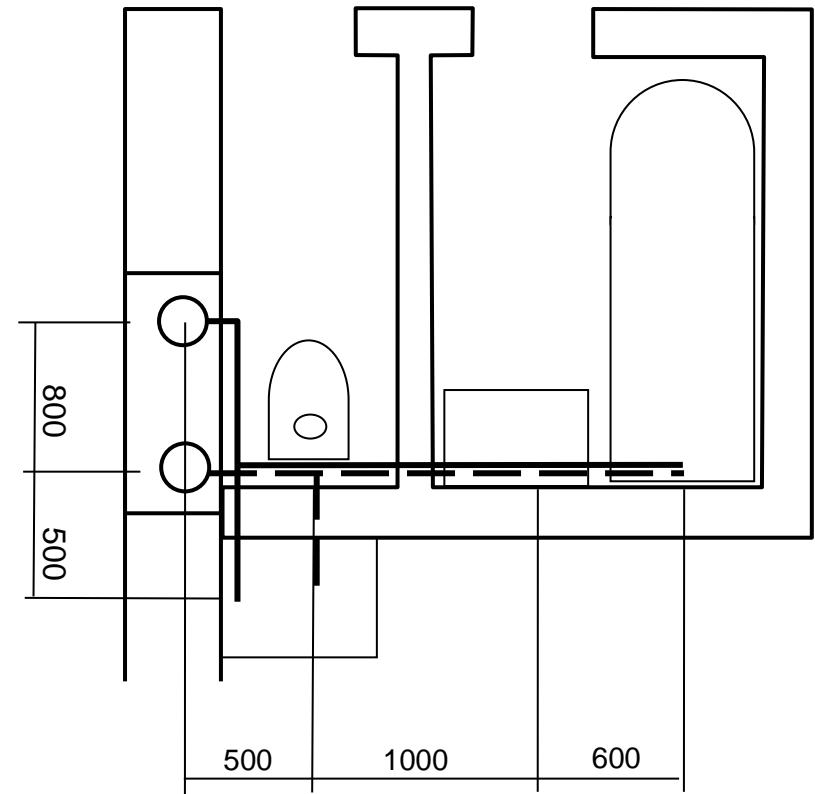
Схема расположения санитарно-технических устройств в секциях
